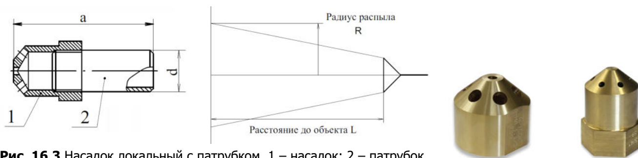
Рис. 16.3 Насадок локальный с патрубком. 1 – насадок; 2 – патрубок.
